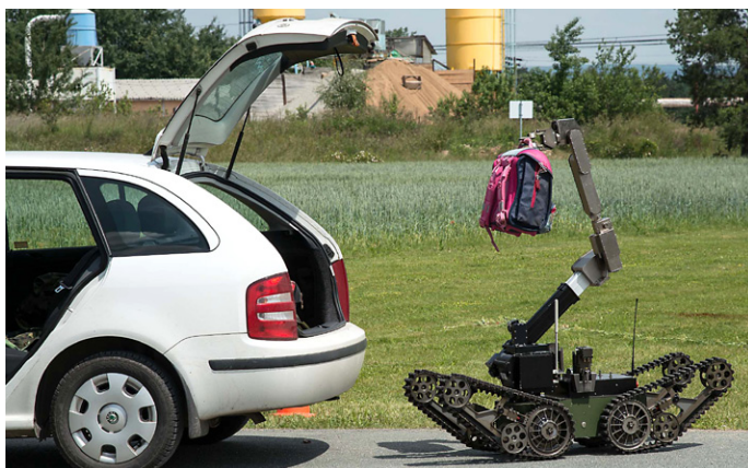
Dálkově ovládaný robot pro manipulaci s výbušninou
